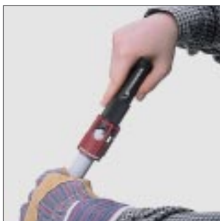
Легкая обработка торца трубы вручную...
