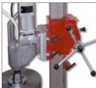
Двигатель быстро снимается благодаря быстроразъемному соединению
