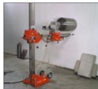
Система горизонтального крепления станины - доп. принадлежность для сверления нескольких отверстий подряд ( № FF35017)
