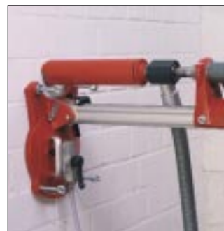
Сверление без подачи воды с использованием станины, отсасывающего ротора и пылесоса
